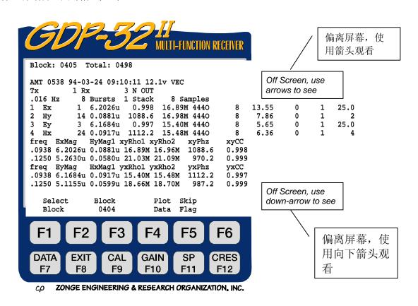
天然场源数据已存储、自电、接地电阻值、前置放大器增益、可变 A-间距以及参考通道 也已存储、但偏向屏幕右侧。
